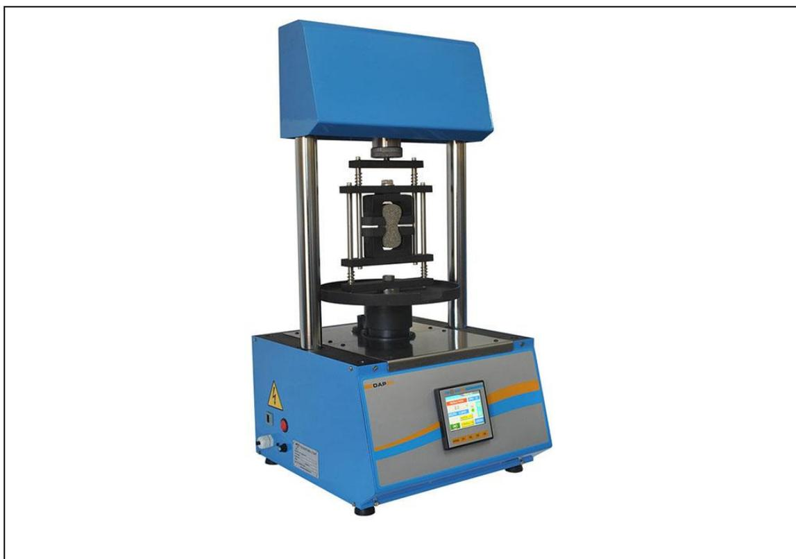
Figura 1 – Foto ilustrativa de uma máquina de resistência à tração a quente para areia coberta.
